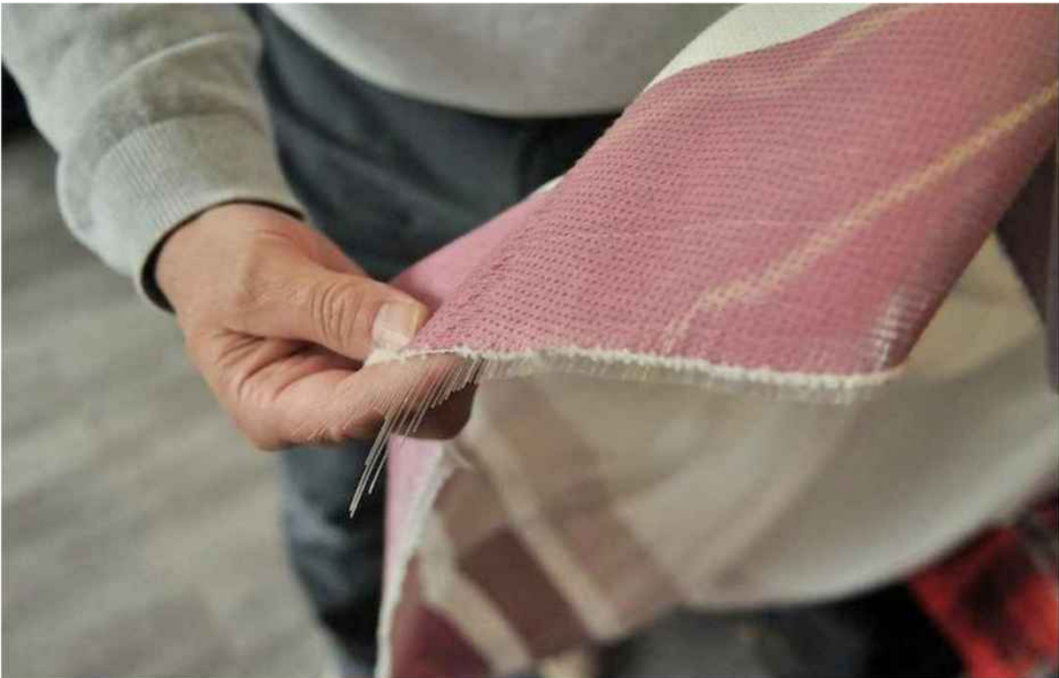
Les machines à tisser croisent la fibre optique dans le sens de la trame avec des fils de coton dans le sens de la chaîne. © Philippe Bohlinger.
